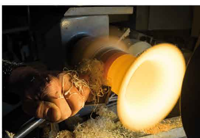
Feindrehen unter Zuhilfenahme einer Lichtquelle
